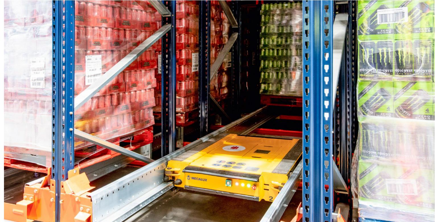
Lisburn (Irlanda do Norte) com o sistema Pallet Shuttle semiautomático da Mecalux para adaptar sua infraestrutura logística à crescente demanda. Esta solução combina alta densidade de armazenamento, acesso direto aos paletes e rigoroso controle de estoque, garantindo a distribuição de bebidas no local e no momento certos.
