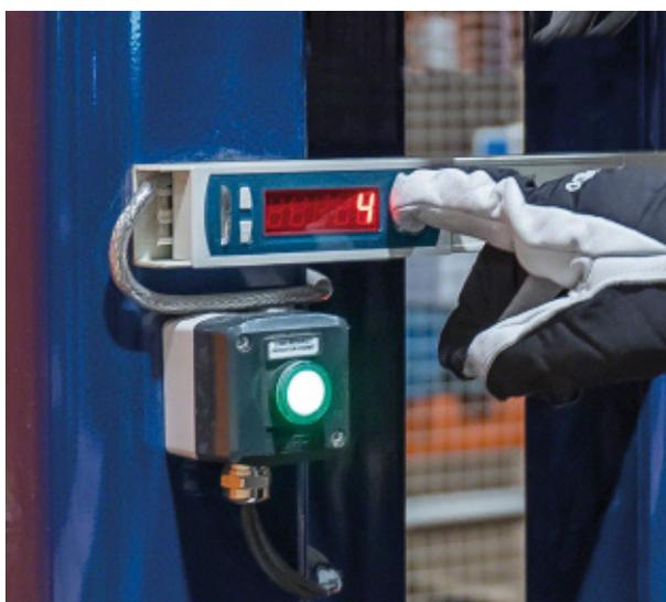
O dispositivo luminoso (*put-to-light*) mostra o número de referências que devem ser colocadas em cada paleta. Uma vez completado o processo, o operador pressiona o botão para informar o SGA. Esse sistema proporciona uma grande agilidade à operação, reduz os erros na preparação de pedidos e permite atualizar o estoque em tempo real graças à transmissão de todas as informações ao SGA.
