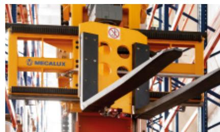
**Elemento extrator.** Sistema de extração com forquilha trilateral, permitindo o acesso a ambos os lados e rotação em torno do próprio eixo, facilitando o acesso à carga.
