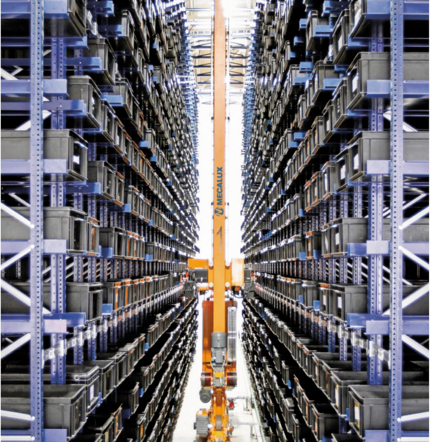
A Mecalux instalou um armazém automático miniload com capacidade de armazenamento para 3.460 caixas no armazém que a Continental possui em Planta Periférico (Guadalajara). O fornecimento também incluiu o software de gestão de armazéns Easy WMS que controla a entrada da mercadoria e a saída dos pedidos finalizados, ao mesmo tempo que garante o máximo desempenho para preparar os pedidos.
