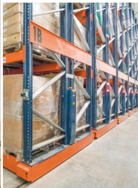
Após analisar as necessidades da empresa, a Mecalux equipou a nova câmara com cinco estantes duplas sobre bases móveis Movirack e duas fixas de 8,8 m de altura e 34 m de comprimento. Isto permitiu obter, no total, uma capacidade de armazenamento para 1.280 paletes com um peso máximo de 1.000 kg cada uma.
