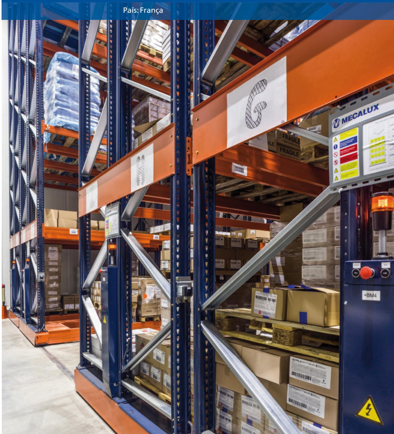
Mecalux instalou o sistema de armazenagem sobre bases móveis Movirack nas instalações que a Entrepôts Frigorifiques Charité possui na localidade de Vaux-Les-Près (França). Através dessas estantes a empresa aproveita ao máximo a superfície para armazenar os mais de 1.000 paletes de seus clientes à temperatura de congelamento.
