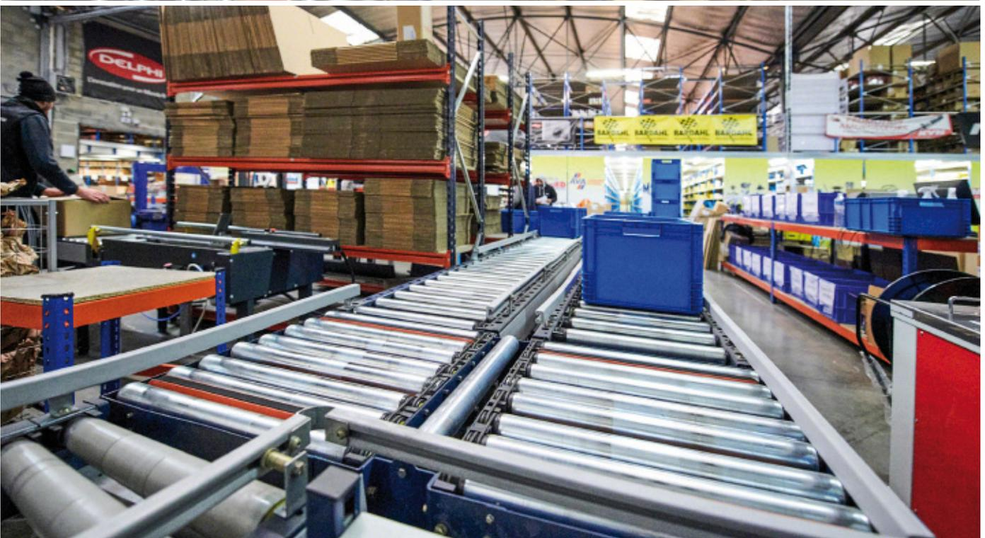
Os transportadores para caixas são elementos de transporte que percorrem distâncias dentro de um armazém. A empresa francesa de peças de reposição automotiva C.D.A.L. implementou um circuito de transportadores da Mecalux em seu centro de distribuição de Saint Priest (ao sul do país), que interliga o armazém à área da expedição de forma automática.
