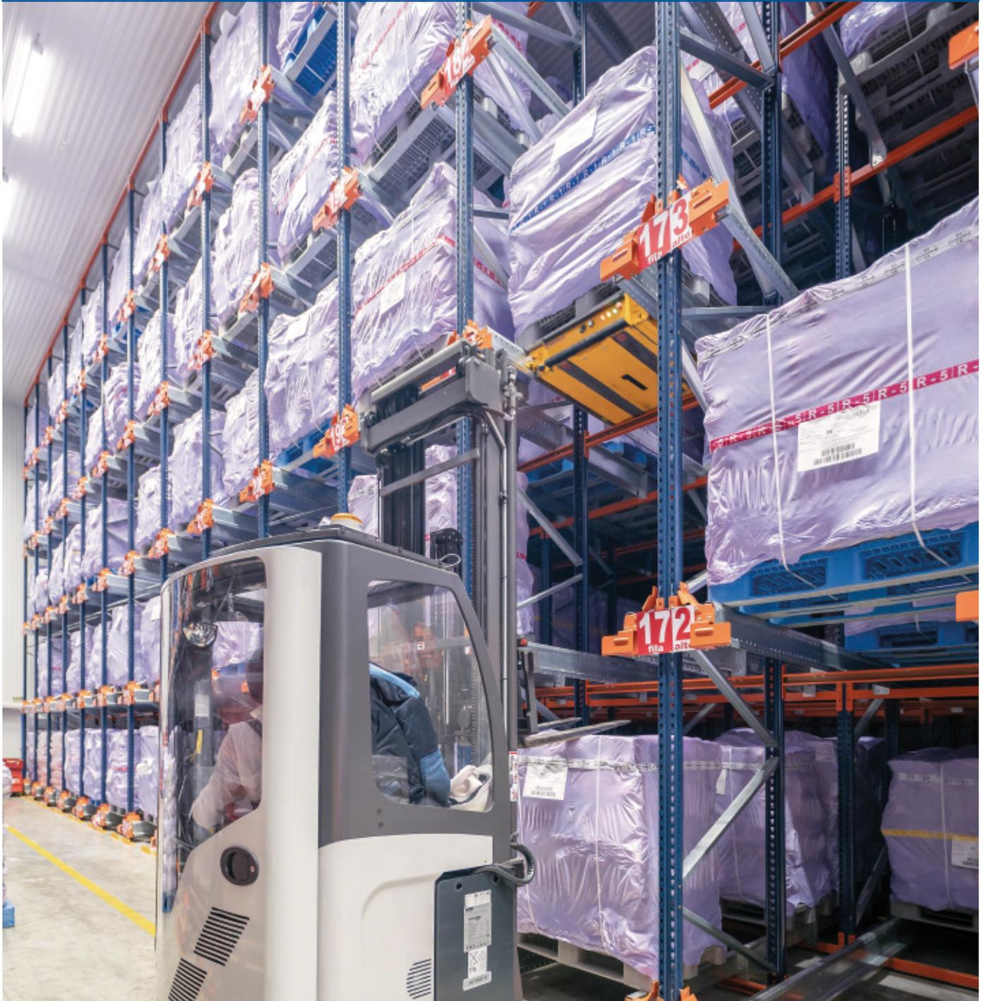
Nos últimos anos, a empresa de carnes El Encinar de Humienta fez um importante investimento a fim de melhorar suas infraestruturas e processos. Por isso, inaugurou uma nova câmara de congelamento de 1.000 m<sup>2</sup> que a Mecalux equipou com o sistema Pallet Shuttle semiautomático. Nela são depositadas 1.997 paletes com os produtos acabados, prontos para serem distribuídos aos seus clientes na Espanha, Europa e Ásia.
