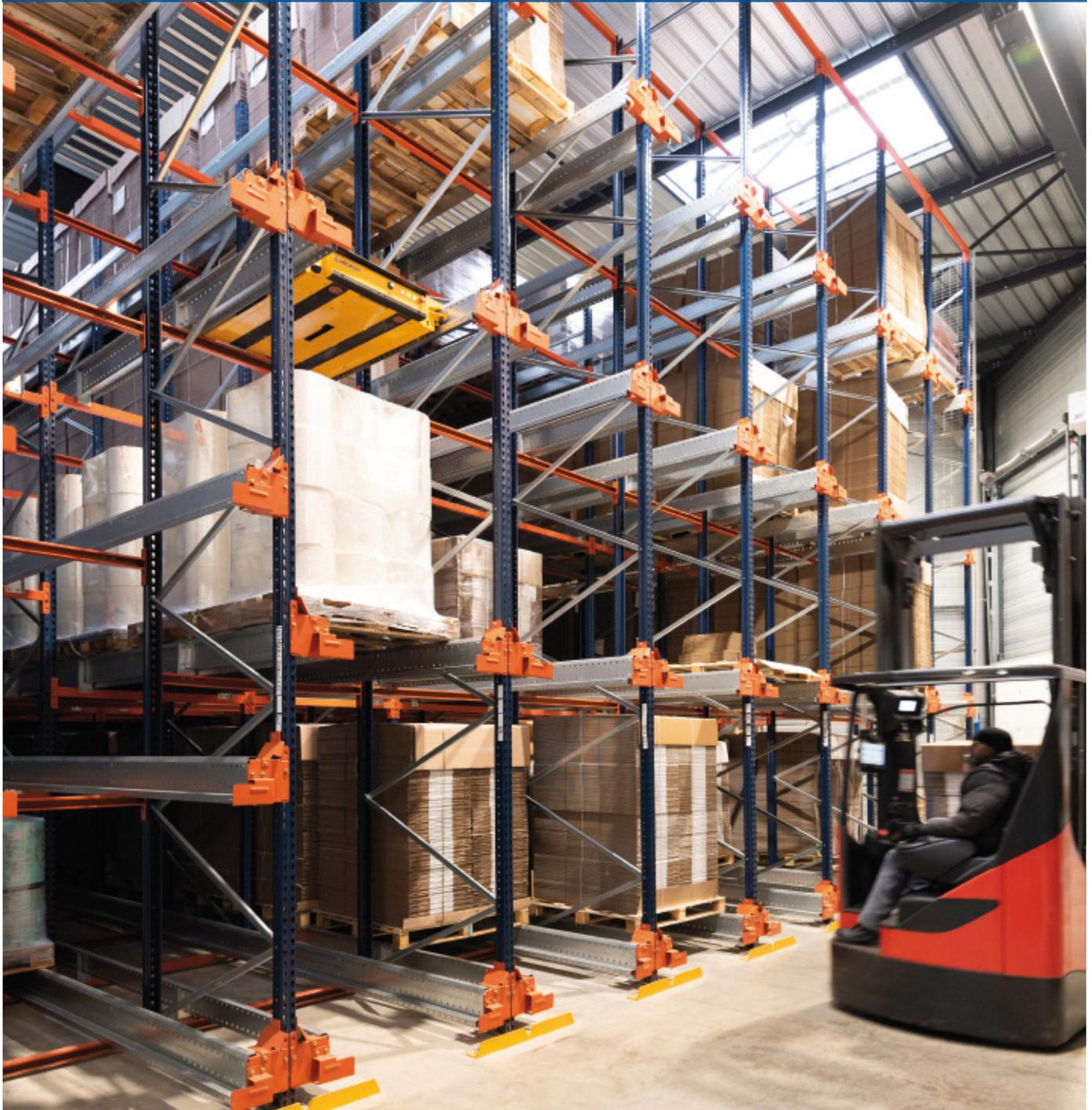
Les Mille Et Une Feuilles, empresa francesa fabricante de folhas de massa brick, inaugurou um novo armazém com estantes compactas com o sistema Pallet Shuttle da Mecalux. Essa instalação tem uma função dupla: enviar as matérias-primas para a fábrica e armazenar os produtos acabados. O Pallet Shuttle, ao ser uma solução semiautomática, oferece muita rapidez às entradas e saídas dos produtos.
