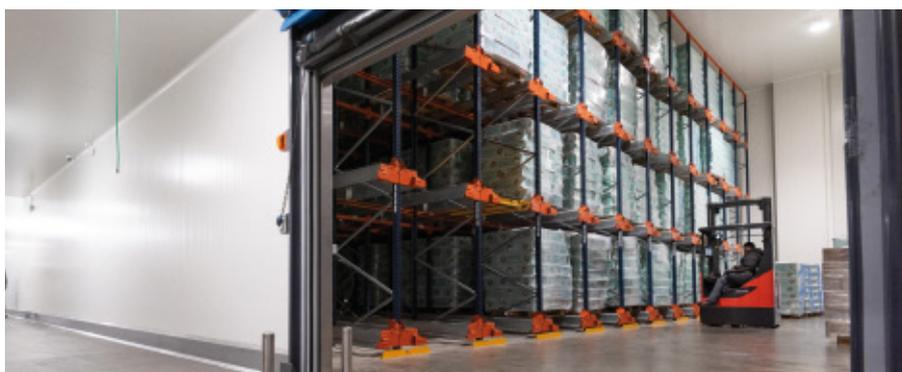
“O funcionamento do Pallet Shuttle destaca-se por sua simplicidade”, afirma Dan Bellaiche. O carro automático encarrega-se de deslocar a carga para a primeira localização livre dentro do canal. Enquanto o Pallet Shuttle transfere e deposita o palete, o operador coloca outro paleta na primeira posição do mesmo canal. Dessa forma, quando o carro Shuttle retornar ao início do corredor poderá repetir sucessivamente o mesmo movimento.
