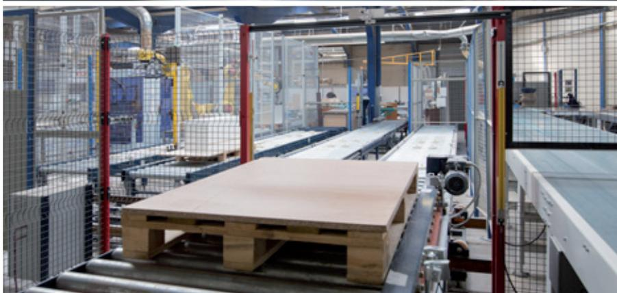
Mecalux instalou um avançado circuito de transportadores no centro de produção da Euréquip, empresa francesa fabricante de móveis. Sua missão é transferir a mercadoria através dos diferentes processos que transformam os painéis de madeira utilizados para a posterior fabricação dos móveis. Este sistema de transporte confere muita agilidade na transferência da mercadoria para as posições exigidas na operação.
