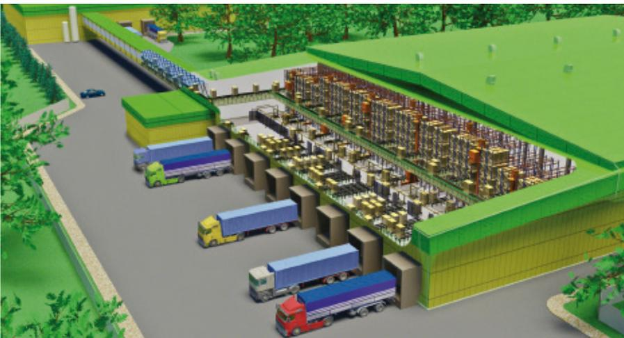
Com o objetivo de seguir o ritmo de seu crescimento, a empresa Zbyszko Company desejava ampliar a capacidade e agilidade de seu armazém, além de integrar seus processos de produção e armazenamento. Visando resolver esta necessidade, a Mecalux construiu um armazém automático interligado à fábrica através de um túnel de 100 m de comprimento equipado com transportadores. Tudo coordenado e controlado pelo sistema de gestão de armazéns Easy WMS da Mecalux.
