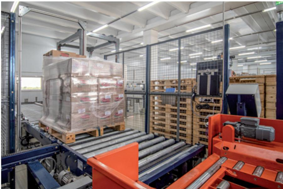
*“Depois de avaliar diferentes opções, optamos por uma solução automática”,* indica Ghersi. Entre as múltiplas vantagens oferecidas pela automatização, também se destaca a otimização da superfície utilizada, pois os equipamentos de movimentação automáticos necessitam de uma menor superfície para manobrar.
