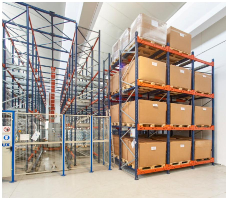
O armazém tem um único corredor por onde circula um translevador com um Pallet Shuttle. Em ambos os lados do corredor, há estantes de 6,5 m de altura compostas por canais capazes de armazenar de seis a sete paletes em profundidade.
