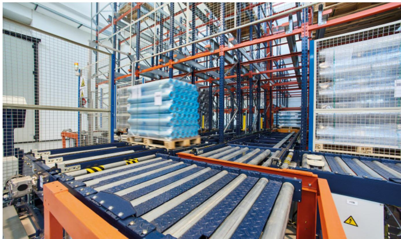
O novo armazém fica exatamente ao lado da fábrica. Os operadores, com o auxílio de empilhadeiras contrabalançadas, coletem os paletes das linhas de produção fazendo sua transferência diretamente para o armazém.
