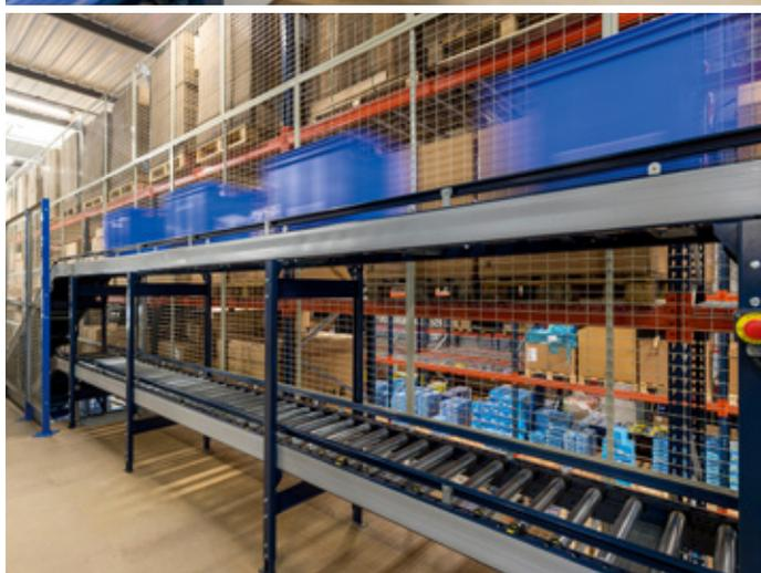
Ao longo do percurso realiza-se uma combinação entre os transportadores de banda e de roletas. As bandas inclinadas são de grande utilidade para evitar os desníveis do armazém.
