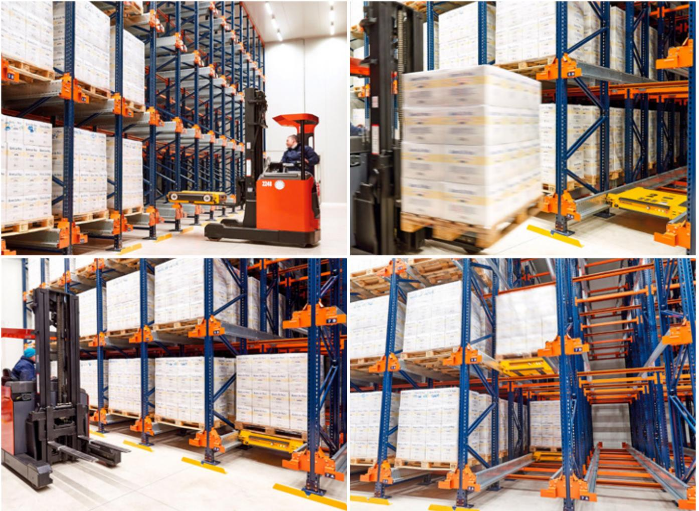
O armazém está capacitado para armazenar 1.494 paletes de 800 x 1.200 mm. Cada um deles pode suportar no máximo 1.200 kg
