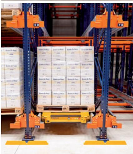
O fabricante de manteiga Burro De Paoli equipou suas duas câmaras de congelamento na Itália com o sistema Pallet Shuttle semiautomático. A solução de armazenamento instalada permite aumentar a produtividade, obter uma capacidade para 1.494 paletes e reduzir a mão de obra.
