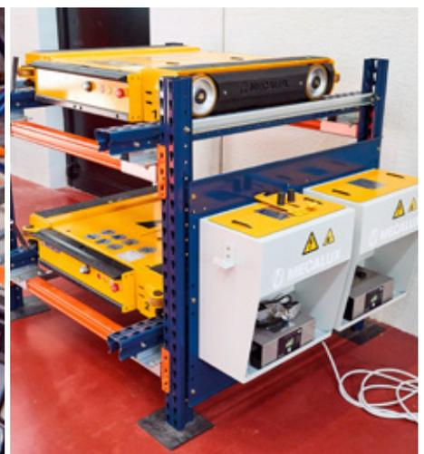
As baterias são extraídas dos carros e conectadas por um simples encaixe nas estações de carga situadas ao lado das docas.
