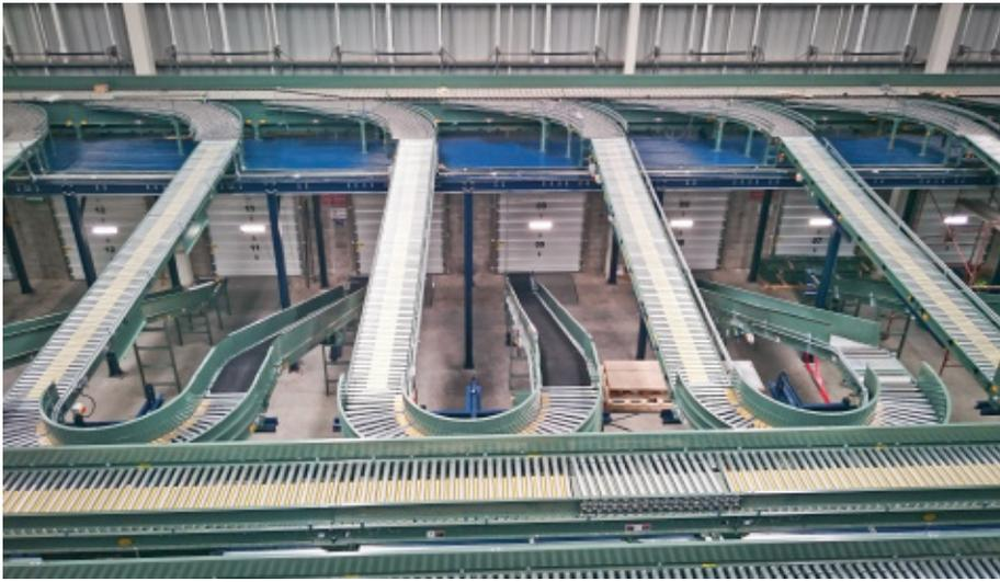
Esta área destaca-se pela presença de um enorme classificador automatizado que classifica por pedidos as caixas provenientes das torres de picking
