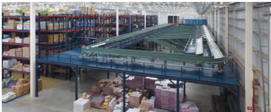
**4. Armazém Pallet Shuttle:** foram instalados dois níveis de estantes compactas com o sistema Pallet Shuttle semiautomático em uma plataforma localizada na frente das docas de carga. Têm capacidade para 512 paletes de produtos de alta rotatividade (tipo A).
