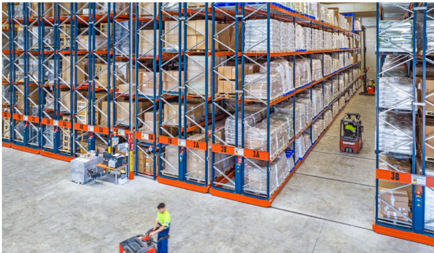
As Estantes Movirack da Mecalux são o único sistema por compactação que oferece acesso direto a todos os produtos armazenados. Como? As estantes são instalados sobre bases móveis que se movem lateralmente sobre trilhos. Quando o operador seleciona a estante à qual deseja acessar com controle remoto, as demais estantes se abrem em cascata, deixando acessível apenas o corredor de trabalho.
