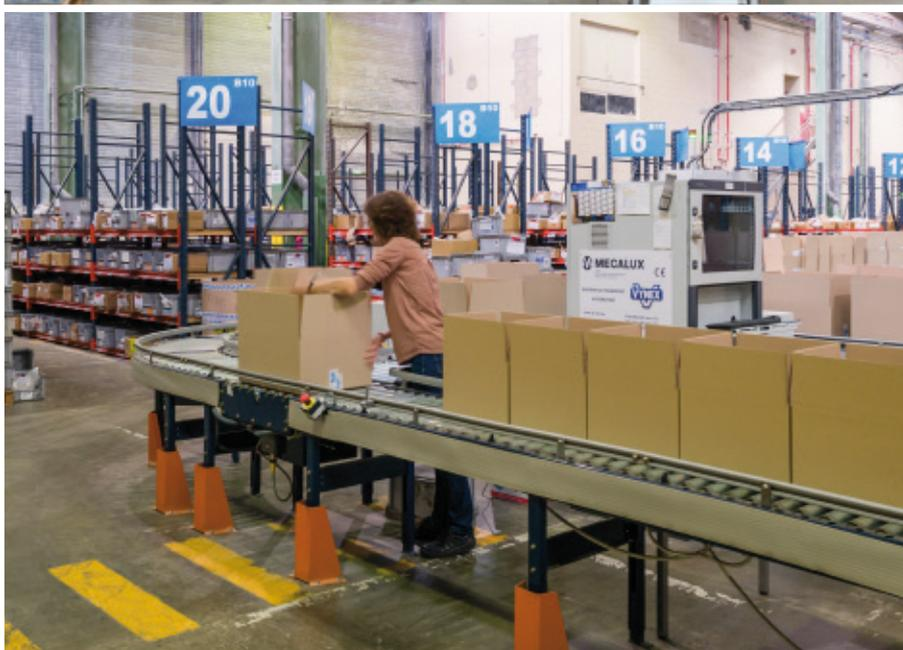
A Mecalux forneceu um circuito de transportadores no centro de distribuição que a Vynex possui na região de Ardennes (França). Esta solução interliga todas as áreas que compõem o armazém, agilizando e aumentando ao máximo o desempenho da preparação de pedidos, principal operação destas instalações.
