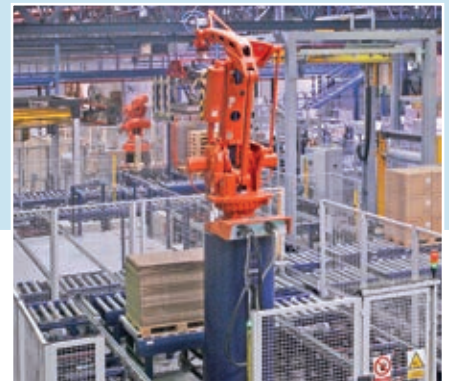
Picking automático com robô despaletizador página 34
