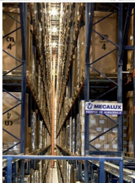
Corredor de armazenamento com transelevador.
