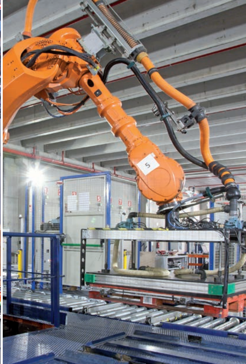
Esquema do funcionamento do sistema com picking automático e robô despaletizador.
