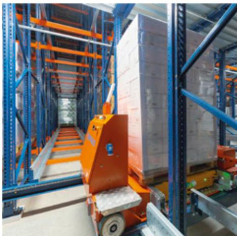
COMBINADO COM OS TRANSELEVADORES, O SISTEMA PALLET SHUTTLE PODE ALCANÇAR ATÉ 40 M DE ALTURA DE ARMAZENAMENTO.
