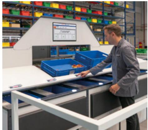
DISPOSITIVOS LUMINOSOS *PICK-TO-LIGHT* AGILIZAM A PREPARAÇÃO DE PEDIDOS E EVITAM ERROS DERIVADOS DO GERENCIAMENTO MANUAL.
