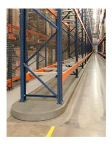
Na entrada dos corredores com sistema de direcionamento mecânico colocam-se perfis de entrada com bocas para facilitar a centragem das máquinas.
