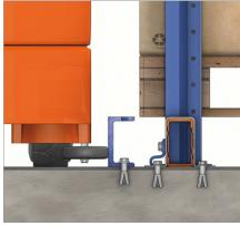
Direcionamento com perfil U4" Os paletes apoiam-se sobre perfis colocados no solo ou sobre longarinas.
