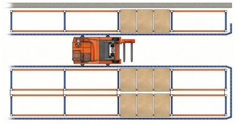
Direcionamento mecânico. Esquema geral
