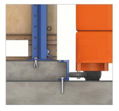
Direcionamento com perfil U4" em forma de ilha Enche-se com concreto o espaço entre as guias de dois corredores, sobre os quais se colocam as estantes.
