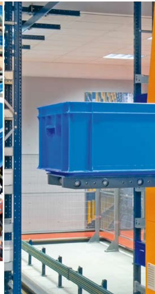
Sistema de extração com pás para retirar duas caixas em simultâneo.
