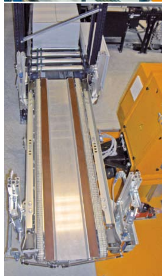
Detalhes do sistema de extração de lâminas combinados com correias (CE).
