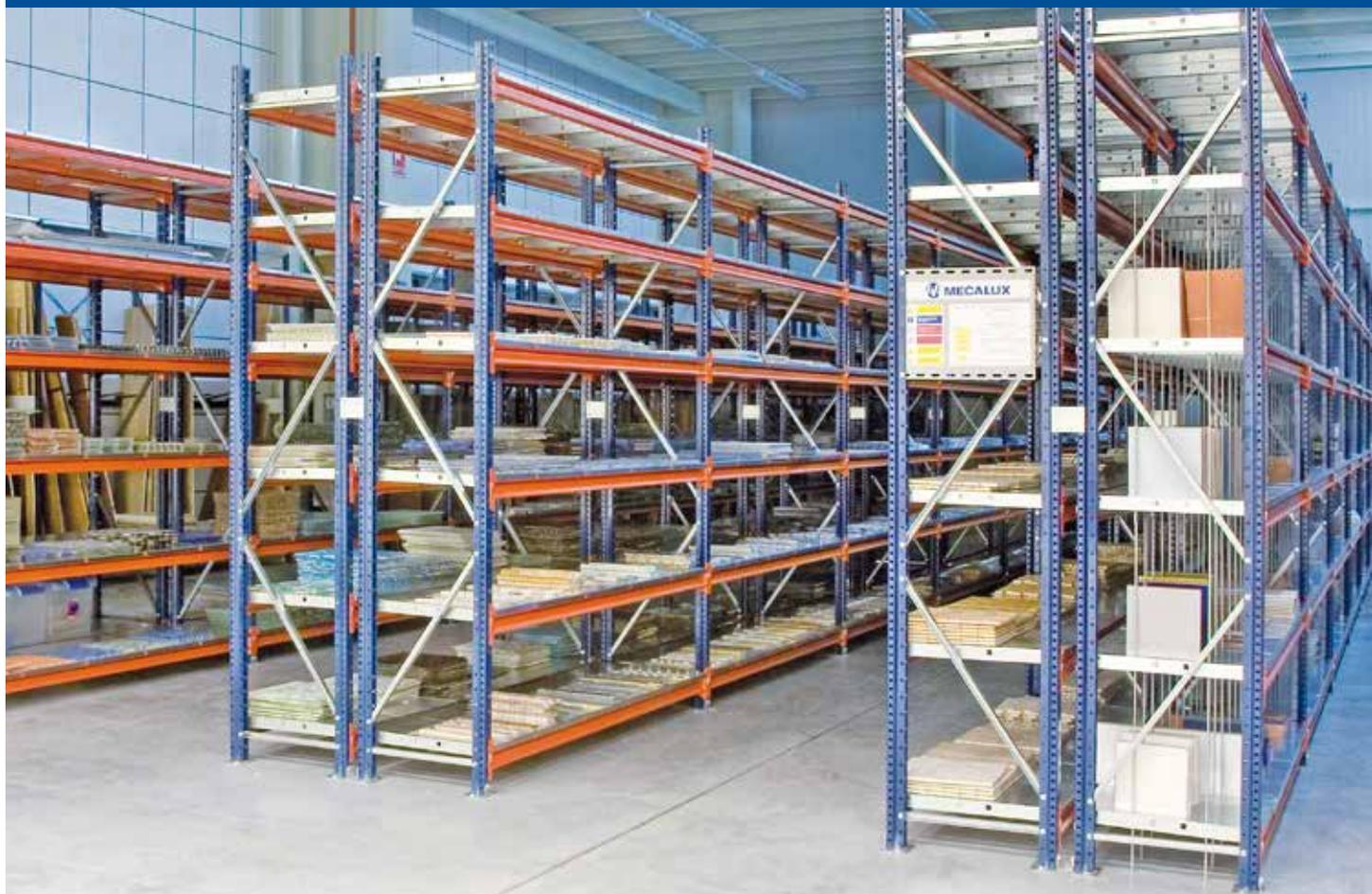
A partir dos diferentes componentes, podem ser realizadas duas composições básicas. Os elementos comuns às duas são os montantes ou pilares verticais e as longarinas disponíveis em diferentes modelos, de acordo com a carga a ser armazenada.
