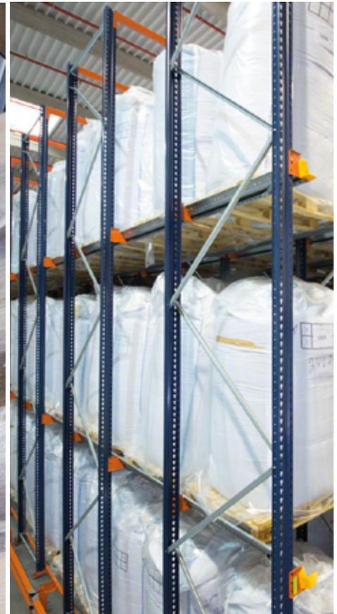
As colunas utilizadas como resultado dos referidos cálculos foram desenvolvidas com uma geometria específica para cada tipo de instalação e cobrem todas as necessidades de armazenagem em função da altura, da carga e da distribuição da instalação (figura 8).
