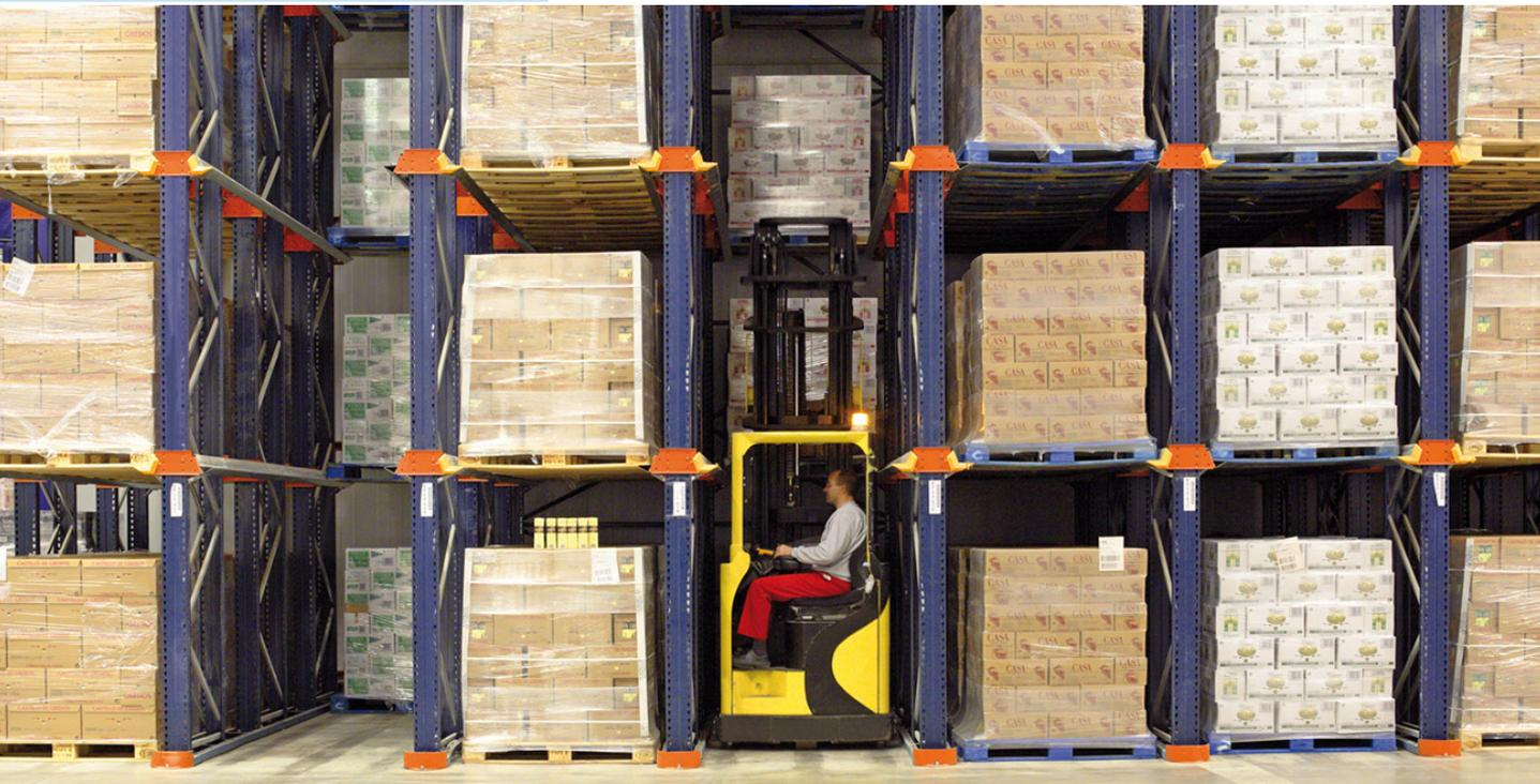
As empilhadeiras circulam pelo interior das ruas de armazenagem, por isso é necessário calcular as margens necessárias para que possam trabalhar com segurança. Existem certas medidas que devem ser levadas em conta ao desenhar a instalação:
