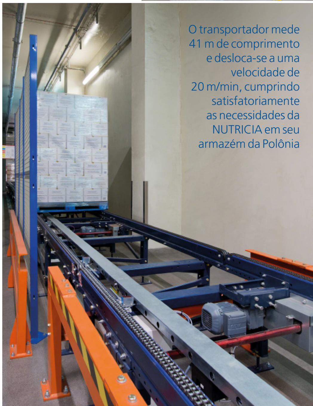
O transportador mede 41 m de comprimento e desloca-se a uma velocidade de 20 m/min, cumprindo satisfatoriamente as necessidades da NUTRICIA em seu armazém da Polônia
