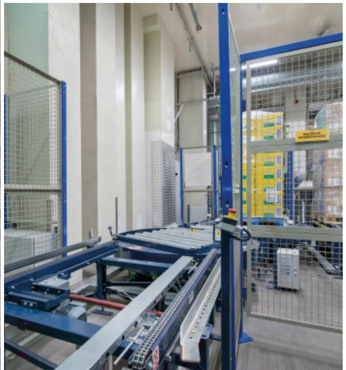
Mecalux instalou um transportador que se encarrega de levar a mercadoria diretamente da fábrica da NUTRICIA para a área da expedição do armazém. Esse sistema de transporte elimina a necessidade de utilização de equipamentos tradicionais de movimentação para deslocar a mercadoria entre os dois pontos. Ao reduzir o manuseio das cargas a segurança da instalação aumenta de forma notável.
