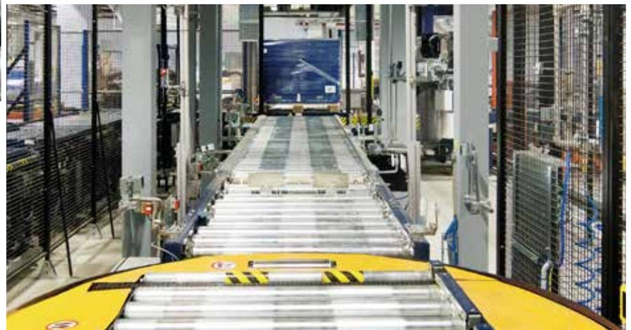
O empilhador/dispensador de paletes agrupa os paletes vazios por meio de um sistema de elevação. Para desempilhar, devem ser depositados nos transportadores um por um. Esse sistema reduz a deterioração dos paletes, mantém a área de armazenamento organizada e aumenta a segurança dos operadores.
