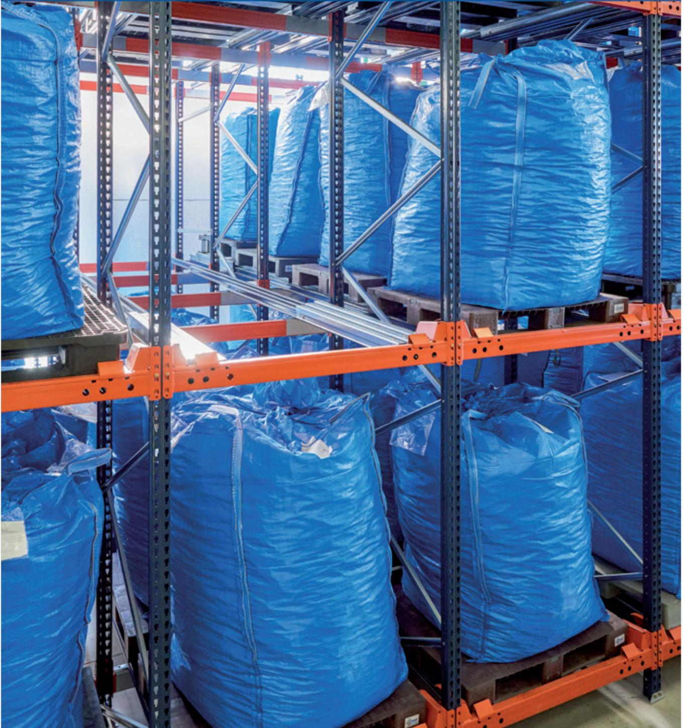
O fabricante de rolhas de cortiça Belbo Sugheri instalou estantes push-back da Mecalux em seu armazém localizado em Calamandrana (Itália). Estas estantes, capazes de receber até 264 paletes, multiplicaram o número de paletes armazenados, além de acelerar seu processo de carga e descarga.
