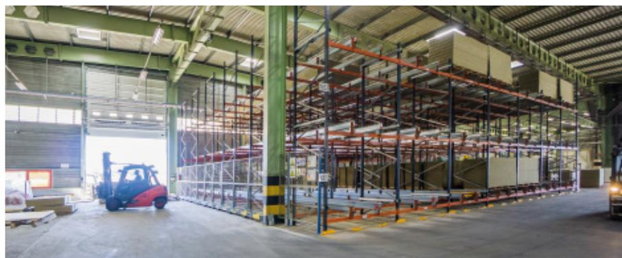
A grande largura dos canais facilita o armazenamento dos paletes de 1.000 x 2.400 mm com um peso de 200 kg
