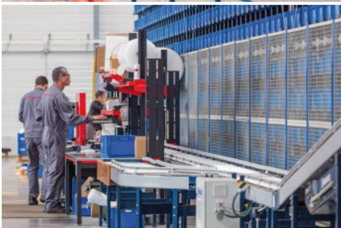
O novo centro de distribuição da Grégoire-Besson, empresa francesa de equipamentos tecnológicos para o cultivo agrícola, é formado por um armazém automático de caixas miniload, estantes de paletização convencional e estantes cantilever da Mecalux. A combinação destes três sistemas de armazenamento, com a implementação do SGA Easy WMS, permite organizar as 10.000 referências com as quais se trabalha em função de suas características e demanda, dinamizando muito a preparação de pedidos.
