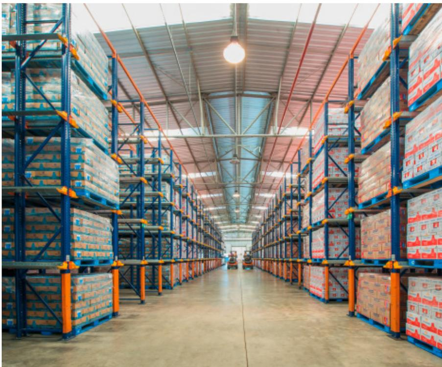
Os operadores, operando empilhadeiras retráteis, entram no interior dos corredores com a carga elevada por cima do nível onde deverá ser depositada. Tanto a carga quanto a descarga da mercadoria é realizada no mesmo corredor, mas no sentido inverso.
