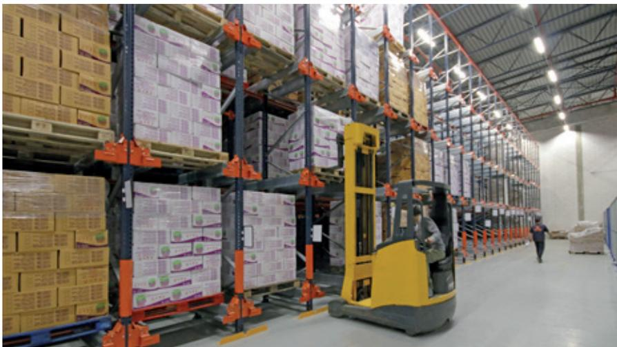
A Firat Food, atacadista de produtos de alimentação e bebidas, reformulou a operação de seu armazém na França com a finalidade de dinamizar a preparação de pedidos. A Mecalux forneceu as estantes de paletização convencional, o sistema compacto Pallet Shuttle e um transportador de roletes, que une as diferentes áreas que compõem a instalação.
