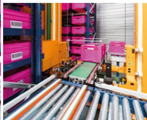
Na parte frontal do armazém automático foi colocada a área de picking, que faz a interligação com as estantes do miniload graças a um circuito de transportadores.
