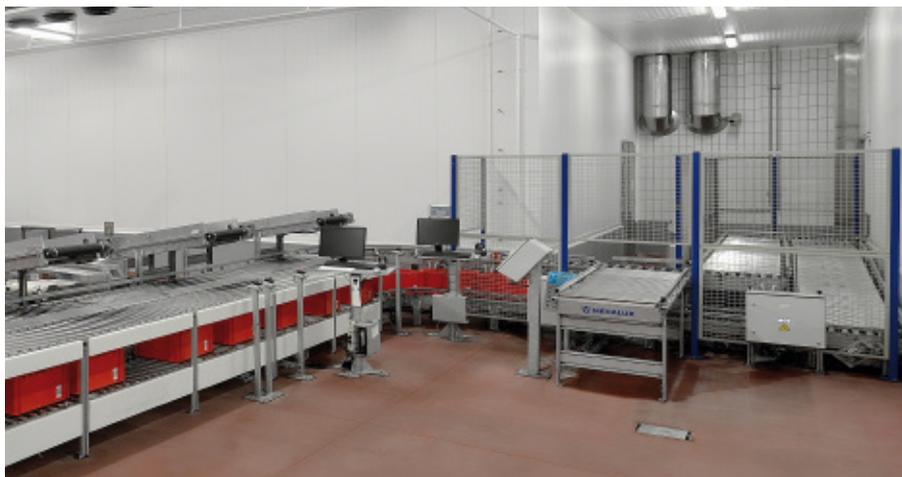
Os produtos são colocados previamente em caixas de plástico – do tipo eurocaixas – de 600 x 400 x 300 mm, formando uma unidade de transporte e armazenagem
