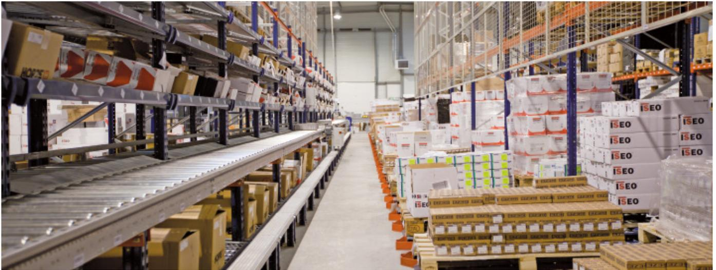
O transportador automático passa pelo interior das estantes, entre os níveis 1 e 2. Pela parte exterior, e paralelamente a este, foi instalado um segundo transportador livre, que tem a função de mesa de preparação. Quando se completam os pedidos, são introduzidos e empurrados para o primeiro transportador e se deslocam até a área de classificação/consolidação. As caixas de papelão, que chegam completas dos paletes, também são introduzidas neste transportador.
