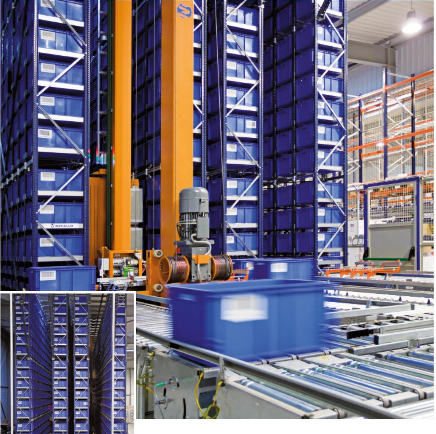
Cogeferm, empresa francesa especializada na distribuição de artigos de serralheria, confiou na Mecalux para realizar o projeto, fornecimento e montagem de diferentes sistemas de armazenagem em seu novo centro logístico de 3.000 m<sup>2</sup> próximo a Paris, entre os quais se destaca um armazém automático miniload. Além disso, a Mecalux implementou seu software de gestão de armazéns Easy WMS, com o qual a Cogeferm controla desde a chegada da mercadoria até a saída dos pedidos.
