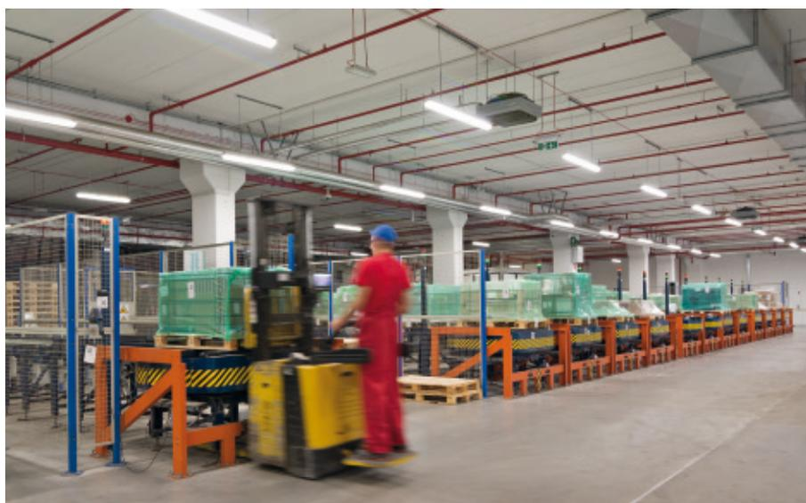
A utilização de paletes escravos garante a resistência das cargas e sua estabilidade tanto no circuito quanto no interior do armazém
