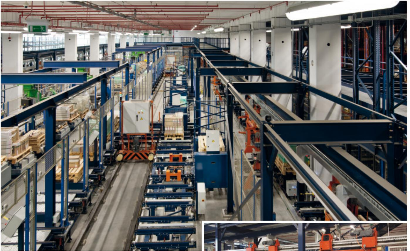
As eletrovias podem chegar aos 100 m/min em trechos retos, velocidade superior à alcançada pelos transportadores
