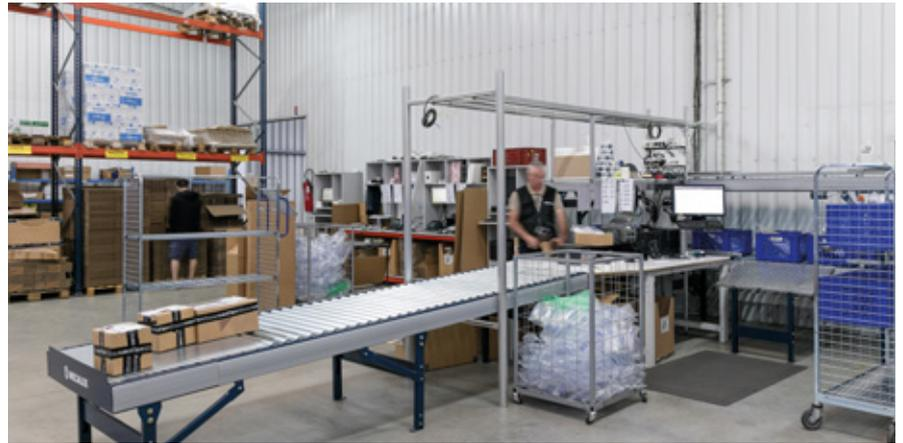
O circuito adapta-se às exigências do centro e incorpora linhas retas, curvas e uma rampa com esteiras para transferir as caixas a uma velocidade controlada do piso superior para o inferior do armazém
