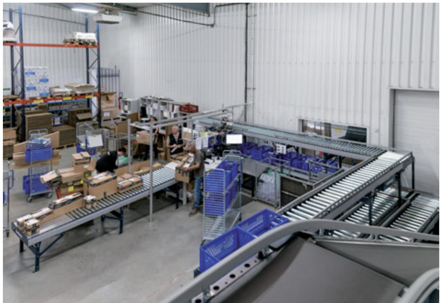
O posto de consolidação dispõe de todos os equipamentos e elementos necessários para consolidar e fechar os pedidos (terminais informáticos, material de embalagem, impressoras, seladoras manuais, etiquetas, material de enchimento, etc.). Uma vez verificados os pedidos, as caixas de cartão são formadas, os artigos são colocados em seu interior e logo são seladas manualmente. Finalmente, estas caixas são enviadas para a área de expedição do armazém.
