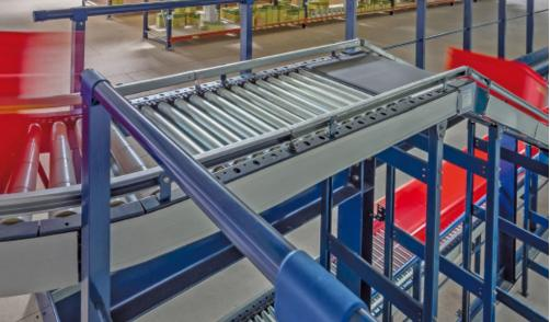
Os transportadores de cintas permitem evitar os desníveis, assim como subir aos diferentes pisos do armazém da PAVI-Groupauto, enquanto os transportadores batentes permitem a passagem dos operadores
