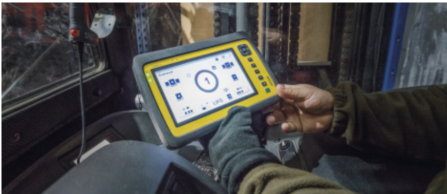
O operador da empilhadeira comunica ao carro as ordens de armazenamento e extração por meio de um tablet com conexão Wi-Fi preparado para trabalhar no frio.
