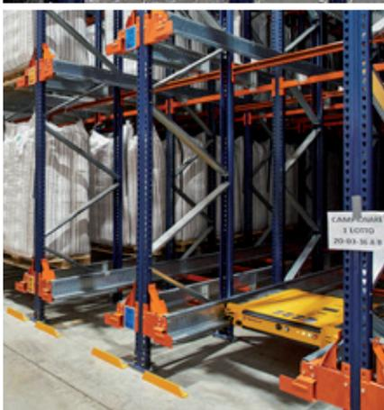
O novo armazém do operador logístico Katoen Natie, na Itália, é composto por estantes convencionais e pelo sistema Pallet Shuttle semiautomático da Mecalux. Essas soluções aproveitam ao máximo o espaço disponível proporcionando uma capacidade de armazenamento para 7.765 paletes. As estantes foram reforçadas para proteger os trabalhadores e a mercadoria contra os possíveis abalos sísmicos.
