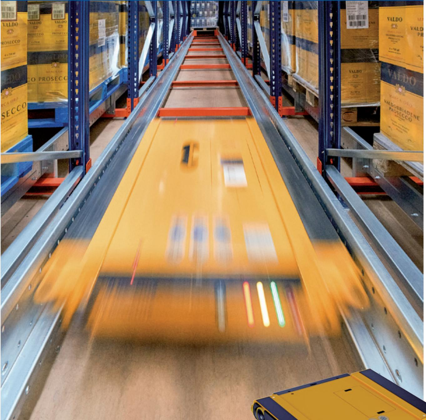
O operador logístico Logistic Net equipou seu armazém de Bassano del Grappa (Itália) com estantes compactas que utilizam quatro carros Pallet Shuttle de Mecalux, encarregados de transportar a mercadoria pelo interior dos canais de armazenamento. Com esta solução a empresa especializada em logística integrada para terceiros pode armazenar mais de 3.000 paletes e controlá-los através de um tablet de controle.
