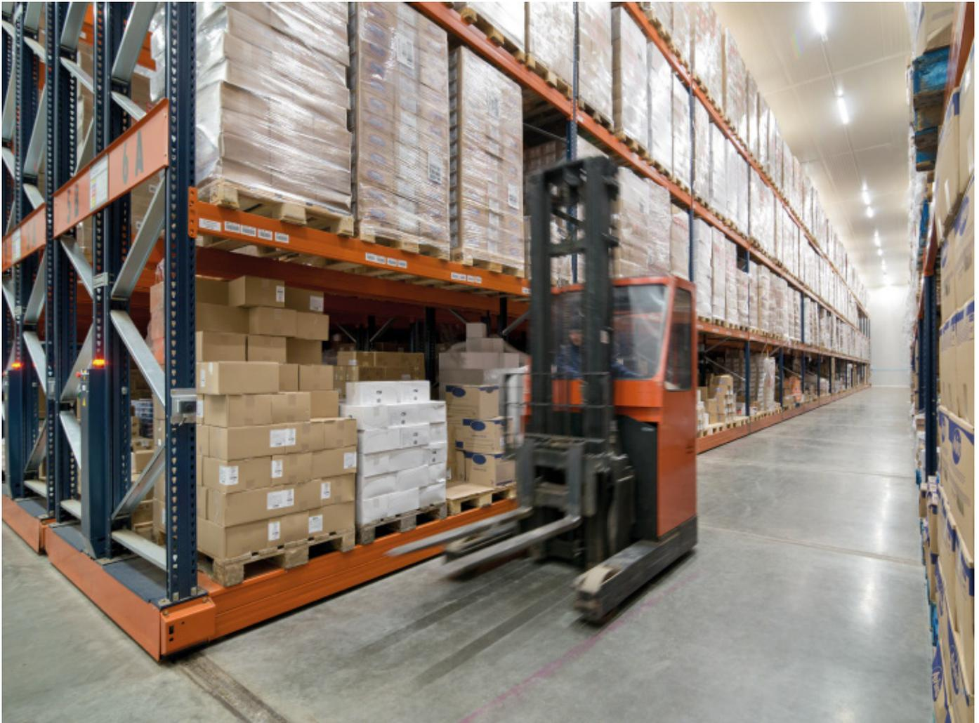
As estantes sobre bases móveis estão dotadas de elementos de translação, equipamentos eletrônicos e dispositivos de segurança para proteger os operadores e a mercadoria armazenada
