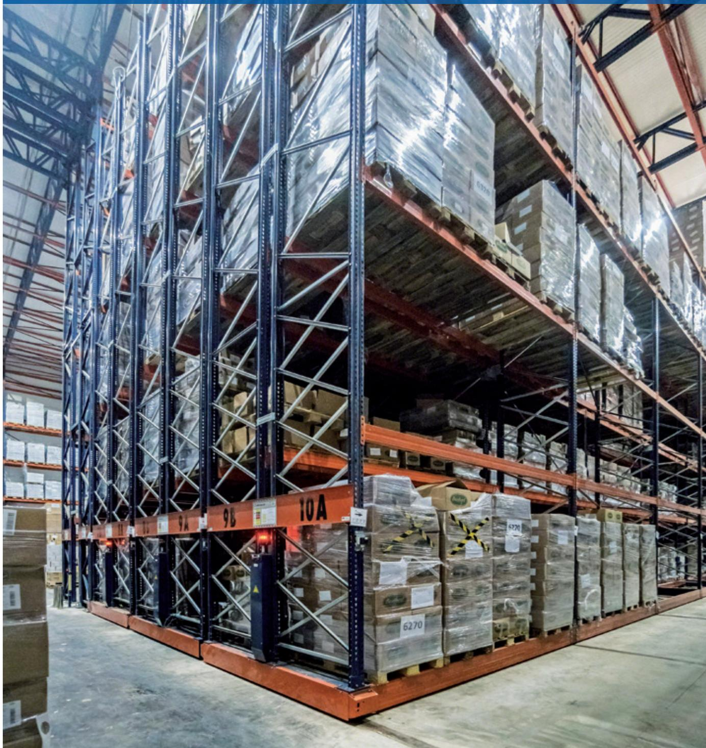
A Mecalux construiu um armazém autoportante e o equipou com estantes sobre bases móveis Movirack destinadas a armazenar os produtos congelados da fábrica de alimentos Benfood. Com esta solução, pensada para armazenar 2.600 paletes em uma primeira fase, a empresa aumenta sua capacidade de armazenamento e reduz os custos logísticos.
