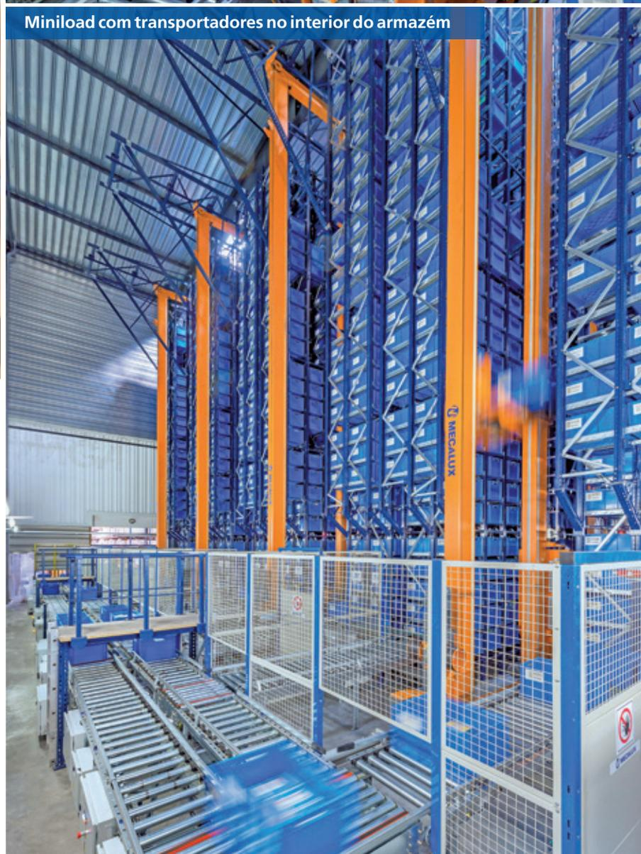
Os transelevadores instalados são de tipo bicoluna, enquanto o sistema de extração localizado no berço é de caixa e profundidade duplas, sendo capaz de manusear duas caixas ao mesmo tempo. O extrator é formado por uma pá e duas correias com movimento independente que permitem retirar indistintamente as caixas de um lado ou outro, movendo a primeira para o lado oposto em relação ao qual vai ser realizada a segunda extração.
