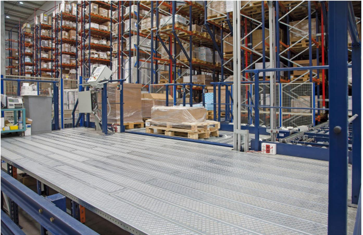
Além do posto de picking instalado na parte da frente, foram disponibilizados ao nível do solo 44 canais dinâmicos para paletes
