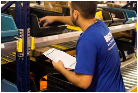
Entre os dois blocos de estantes dinâmicas há estantes de picking dinâmico. São formadas por três plataformas com roldanas e têm uma leve inclinação para que as caixas se desloquem por gravidade. A vantagem dessas soluções para o picking é que sempre haverá estoque disponível permitindo efetuar a operação.
