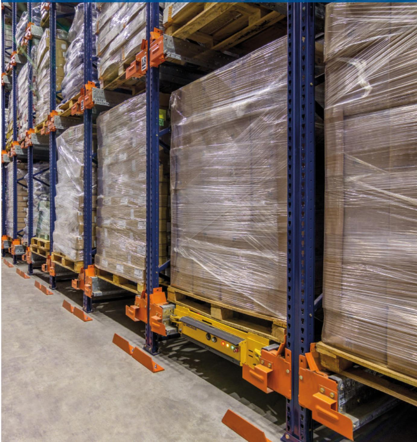
O operador logístico argentino Frío Dock inaugurou um novo armazém em Tortuguitas (Buenos Aires) para lidar com o aumento da produção de seus clientes. A Mecalux equipou o armazém com dois blocos de estantes que utilizam o sistema Pallet Shuttle semiautomático, proporcionando uma capacidade de armazenamento para 2.280 paletes.
