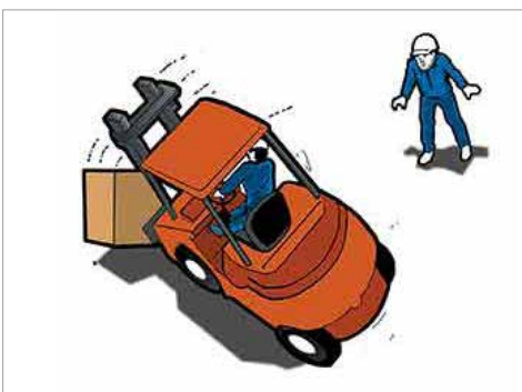
Figura 8. Perda do controle da empilhadeira.
