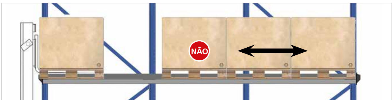
Não arrastar os paletes sobre as vigas.
