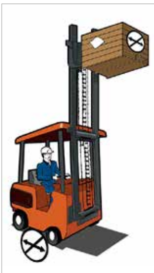
Figura 1. Não circular com cargas elevadas.
